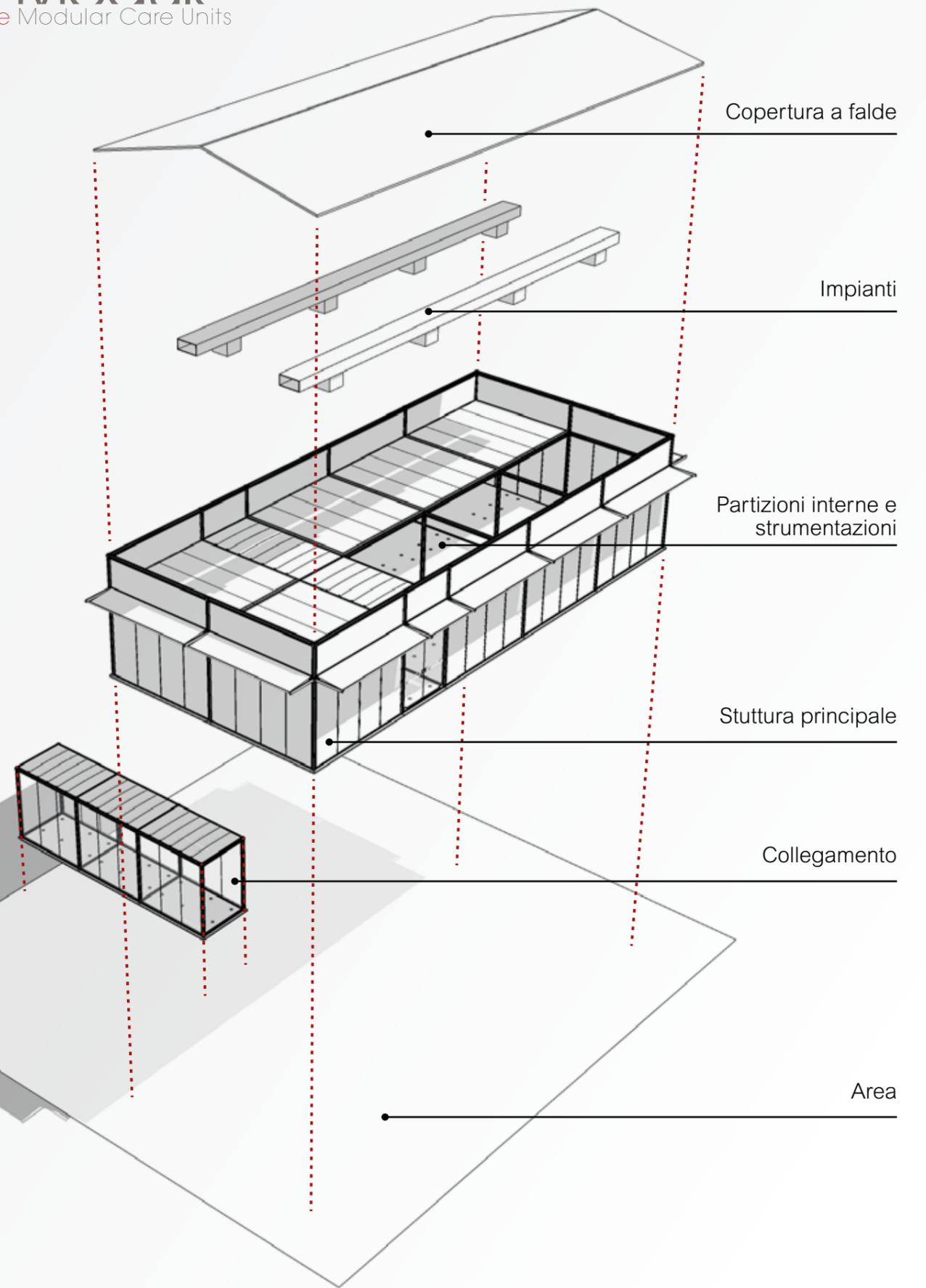
TModule rappresenta la soluzione modulare ingegnerizzata per la realizzazione di reparti ospedalieri esterni completi di involucro, partizioni interne e impianti, pronto all'uso in tempi estremamente contenuti. TModule può essere raccordato a strutture ospedaliere esistenti attraverso corridoi di collegamento completamente personalizzabili.
